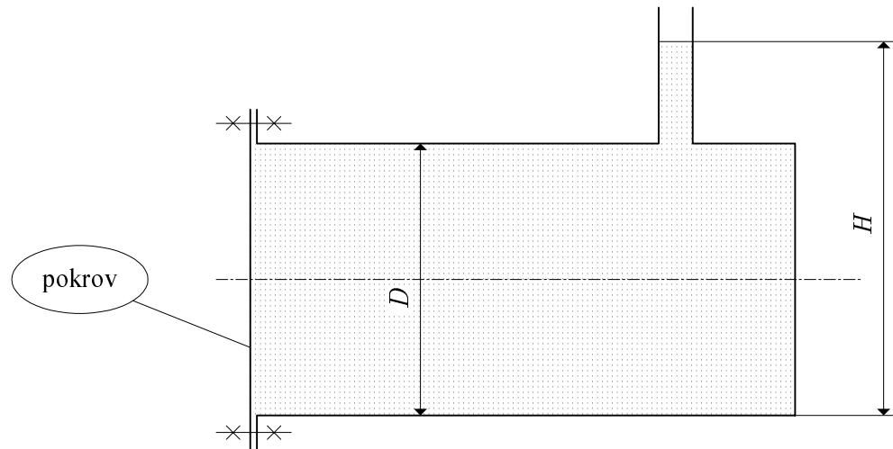
Izpeljite enačbo za hidrostatično silo, ki deluje na pokrov.
