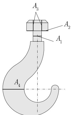
V točkah a), b), c) in d) so našteti različni načini obremenitve. K vsaki obremenitvi napišite oznako prereza, v katerem nastopa navedena obremenitev.
