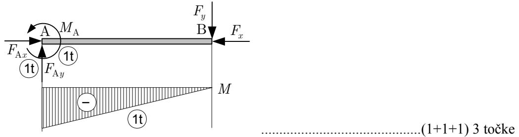
$\sum F_{ix} = 0; F_{Ax} - 136,8 = 0 \Rightarrow F_{Ax} = 136,8 \text{ N}$  ..... 1 točka
