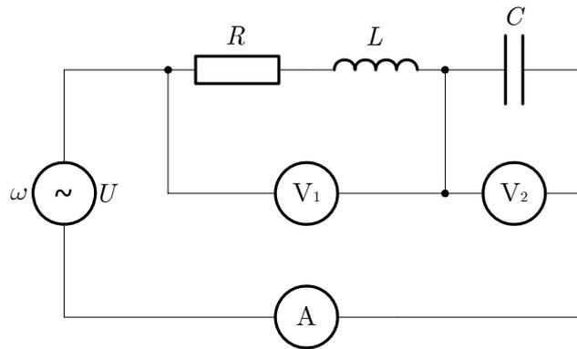
a) Kolikšen je odčitek z ampermetra v resonanci?
