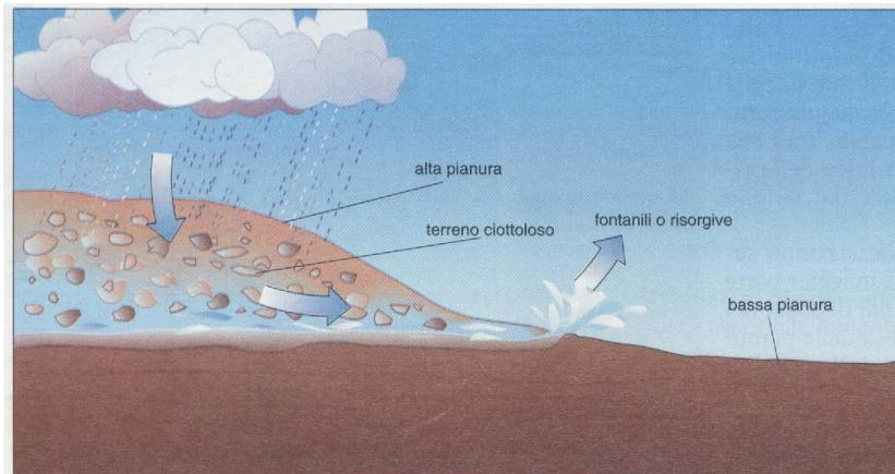
A lato, schema di una risorgiva. Le acque piovane, cadute sui terreni ciottolosi dell'alta pianura, penetrano fino a incontrare gli strati impermeabili, sopra i quali si fermano dando origine alla falda freatica; dove la falda freatica incontra la superficie del terreno impermeabile si formano le risorgive.
