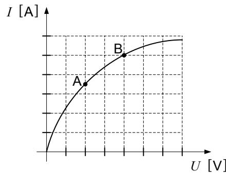
Dinamična prevodnost  $g_A$  v točki A je v primerjavi z dinamično prevodnostjo  $g_B$  v točki B
