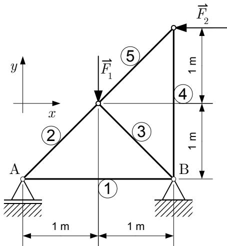
1.1. Kako imenujemo konstrukcijo? Imenujte podpore in z ustrezeno enačbo ugotovite, ali je konstrukcija statično določena.
