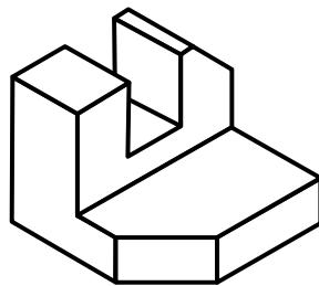
Disegnate i tre spigoli mancanti (visibili e invisibili) nelle singole viste della proiezione ortogonale.
